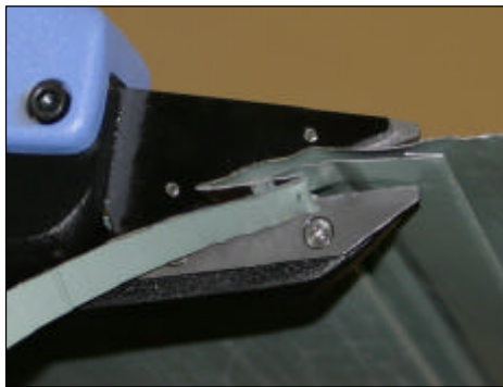
横葺成型材の切断
